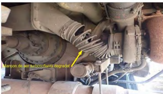
Foto nr.9 - Manșon degradat.
