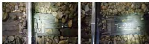
Imagina 8 - Traversa situată anterior căderii roții din partea dreaptă între firele căii
