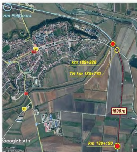
Figura nr.3 – Locul producerii accidentului – imagine satelit. Distanța de 1696 m parcursă de vagonul cu boghîul nr.2 deraiat
