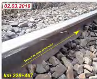
Foto nr. 3 - Urmă produsă de fața laterală exterioră a bandajului roții din stânga osiei nr.6
