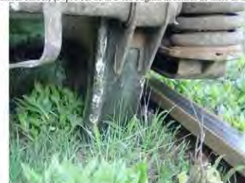
Fotografia nr. 7: Detaliu cu prima roată (R1) deraiată a trenului
