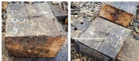
Imagina 10 - fragmentul 1 - inimă roșie, crăpături pe fața superioară și în adâncime, putrezire la partea inferioară
