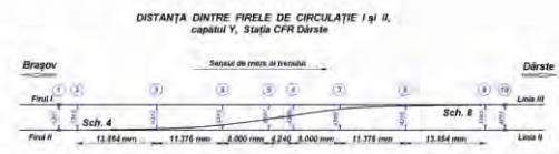
Figura nr.6 – Distanța dintre axele firelor de circulație I și II, capătul Y al Stației CFR Dârste
