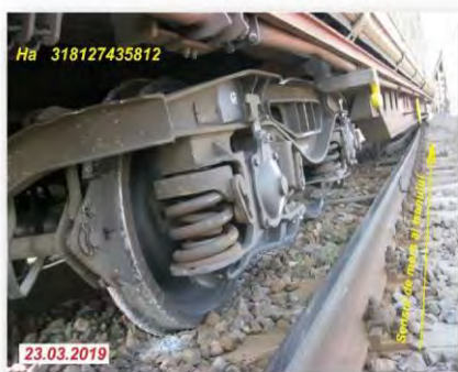
Foto nr.3 - Poziția boghiului nr.2, deraiat, după oprirea trenului
