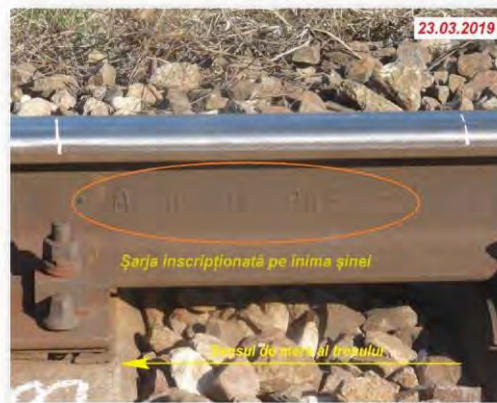
Foto nr.4 - Șarja inscripționată pe inima șinei cu rupere multiplă
