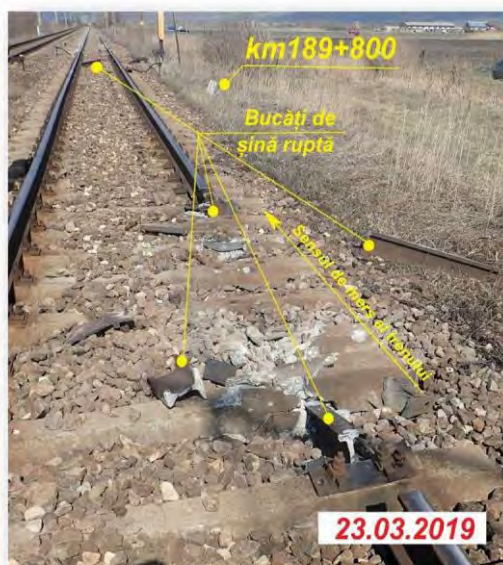
Foto nr.5 - Bucățile de șină ruptă (pozițiile în care au fost găsite de comisia de investigare)
