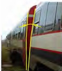
Cutia vagonului se înclină spre perna de aer dezumflată
