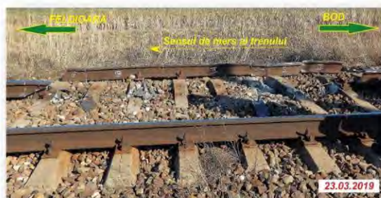
Foto nr.6 - Reconstituirea șinei cu rupere multiplă
