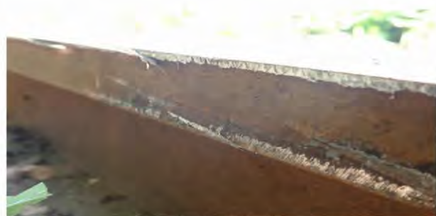
Fotografia nr.1 Detaliu cu urme de frezare specifice căderii roții (R1) la interiorul căii (șina de la firul interior al curbei/zona punctului 0)
